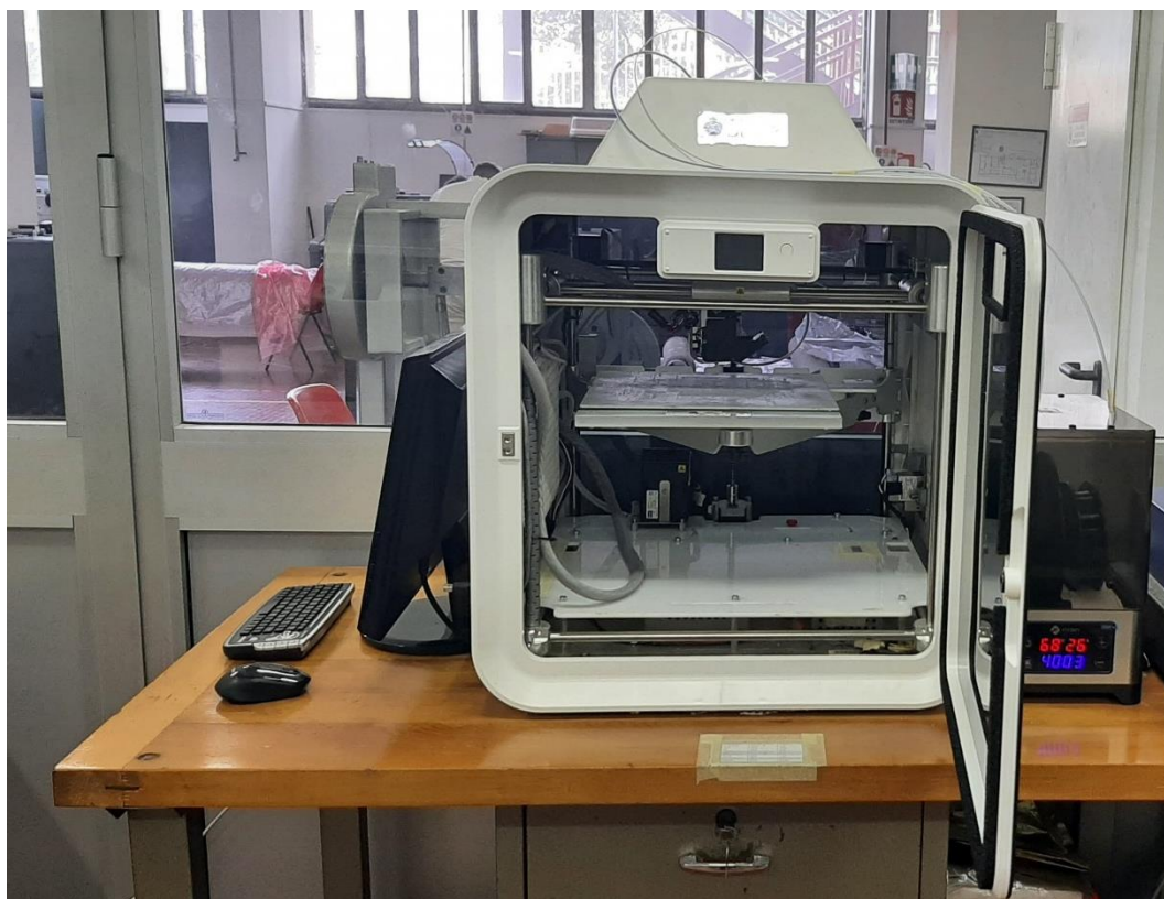
Fig. 2 – Stampante CubePro Duo adattata alla tecnologia Continuous Fiber Fabrication
